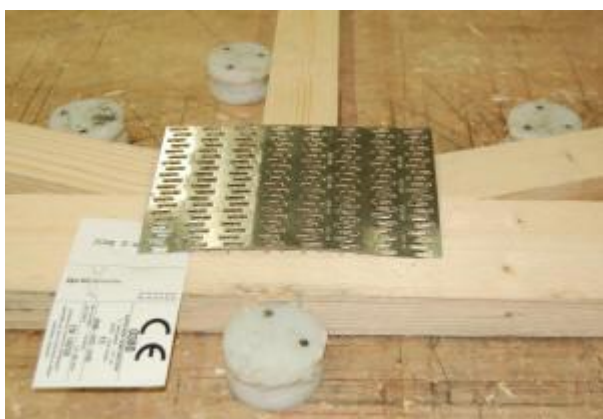
Mise en place du connecteur avant pressage
