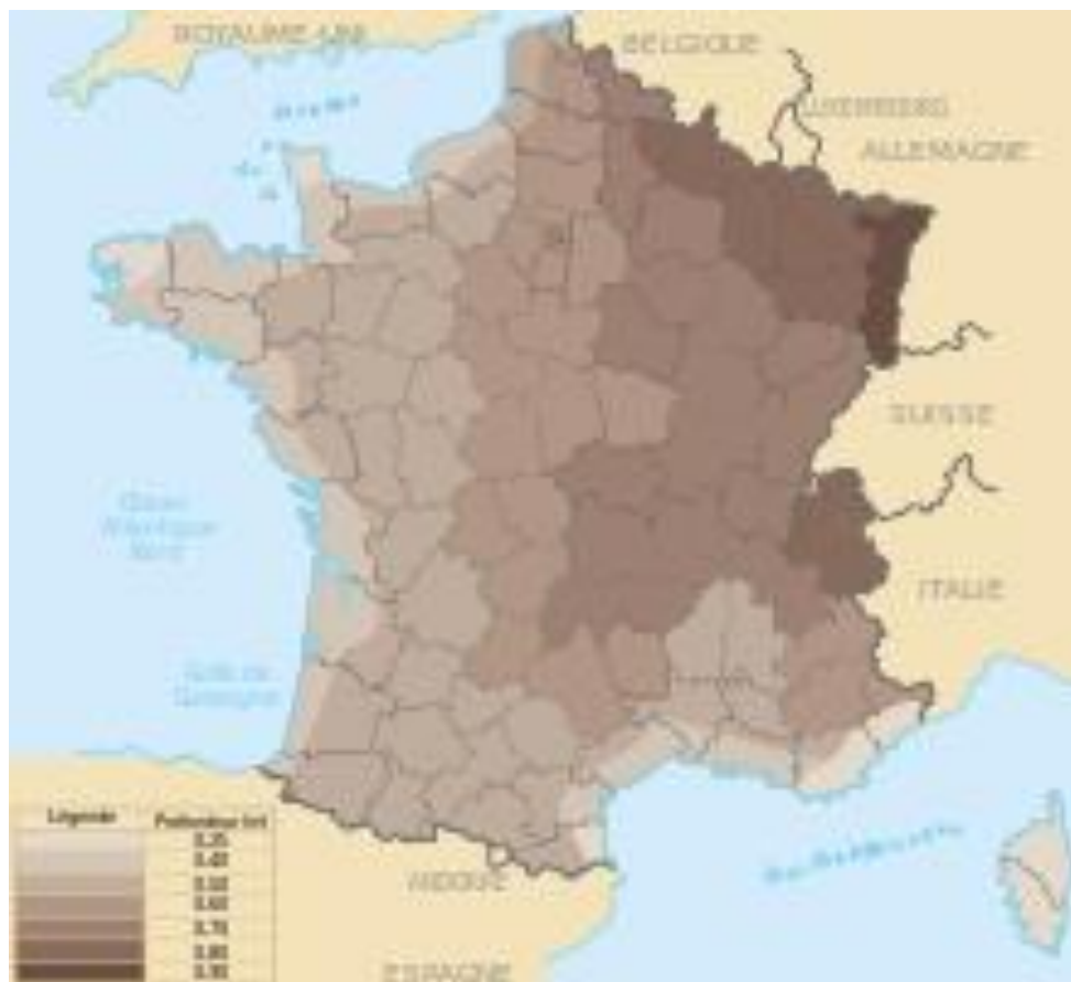
Carte de France déterminant la profondeur des fondations à une altitude de 150 m
