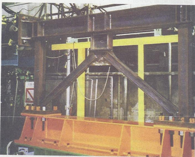
Figure 42. Palée de stabilité à barres excentrées (Photo : M. Zacek).
